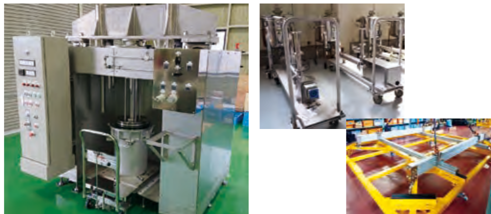
製作事例 「医療用脱泡・充填装置」(左)と、「コーティング原料の塗液供給装置」(中)、第10世代用機材搬送台車(右)。 図面にあわせて迅速・的確に必要な部品や資材を製作・手配し、組み立てる。
