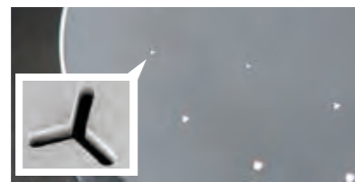
合成繊維の口金。穴をY型に作った糸は、繊維にしたとき絹のような光沢が生まれる。
