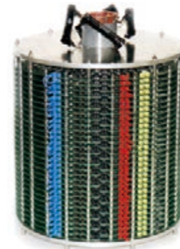
数十万ボルト、数千アンペアという大電力を用途に合わせて自在に制御する同社のパルス電源。写真は出力電圧波形をパソコンで自由に変えることができる「スマートパルスパワー電源」
