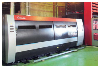
高性能の板金切断機で歪みを抑えた加工を行う
