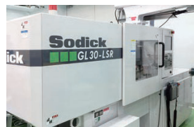
本社工場のLSR成型機 液状素材を熱硬化させて成型する
