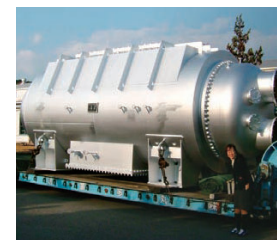
蒸気を水に戻す「復水器」 こうした巨大な製品も珍しくない
