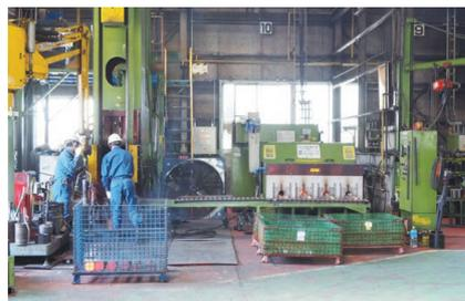
3.5mの高さからハンマーを落とし、1500トンの力を加えるボードハンマー
