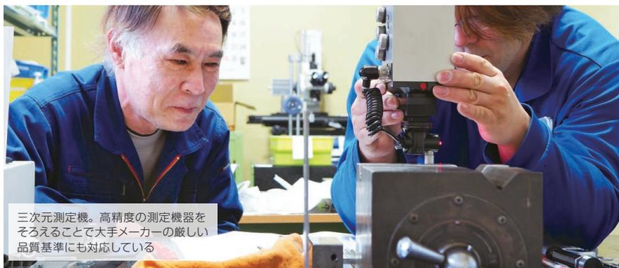
三次元測定機。高精度の測定機器をそろえることで大手メーカーの厳しい品質基準にも対応している
