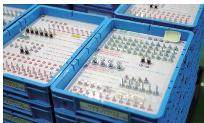
部品の紛失を防ぎ、作業が円滑になるよう磁石で部品が固定されたパレット。現場力活動から生まれたアイデアの一つ
