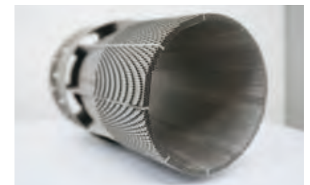
宇宙空間で太陽を測定する装置の重要な部品「プレ・コリメーター」。3Dプリンターを用いて完成させた。
