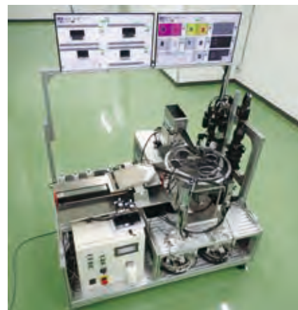
オリジナル製品「トレフィータ」は製造工程で用いるパーツフィータ。部品を振動で搬送する代わりにエアで浮かして運び、振動による部品の破損や静電気を抑える。
