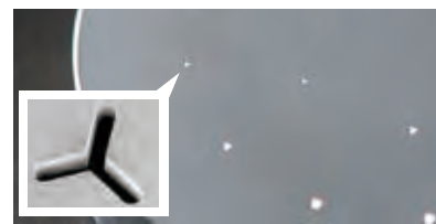
合成繊維の口金。穴をY型にしてつくった糸は、繊維にしたとき絹のような光沢が生まれる。
