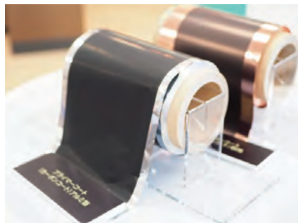
アルミ箔に黒鉛導電性塗料を塗布し、電気抵抗を小さくした「プライマーコート箔」。電池の高容量化を実現する電極として広く使われている。
