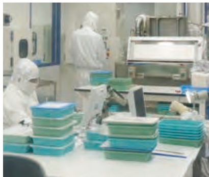
医療機器は手術室と同等クラスのクリーンルームでつくられている
