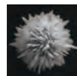
▲世界初の毬栗状銀粉を開発し、少ない量で導電性を高めた導電性銀ペースト「TKペースト」はサポイン事業に採択された
