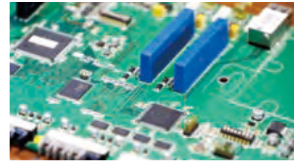
高い負荷がかかるパルス電源において、真空管に代わり、半導体で精密に制御する技術を確立した
