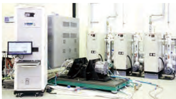
テクノファクトリーでは大手メーカーにもない高精度のモータ試験装置がフル稼働している
