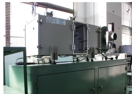
▲サポインの補助金で導入した、ファン風力測定装置。従来よりも、より正確な測定値を出せる高性能なもの。
