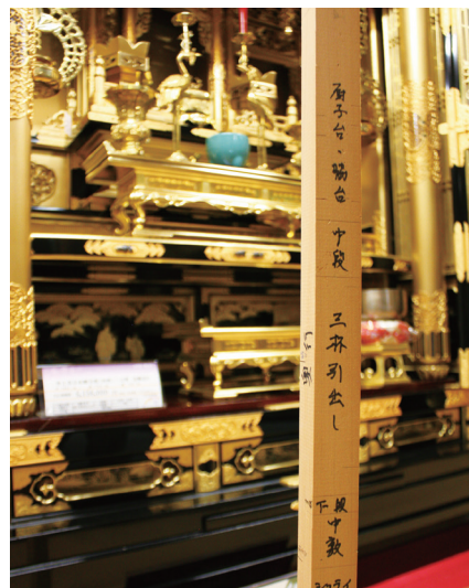
▲仏壇の設計図「杖」。1本の棒に印をつけただけのものだが、職人が見れば仏壇の全体像がわかる。
