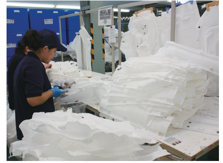
▲自動車の座席内部の補強材。成形した後、手作業でトリミングしなければならないが、サポインを利用し、成形とトリミングが同時にできるシステムを開発した。
