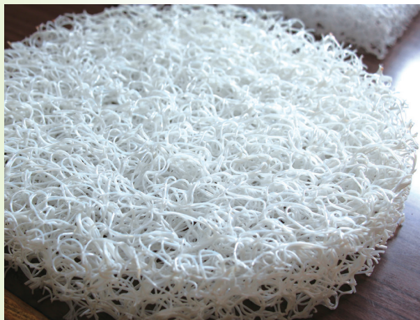
▲BREATHAIR®の断面。 密度・厚み・大きさの調整により、ニーズに応じた製品設計ができる。
