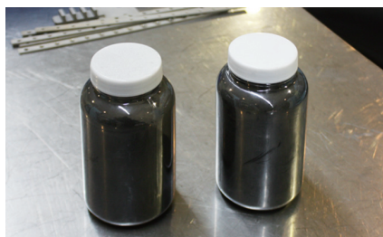
▲サンプル販売を開始したオニオンライクカーボン。炭素原子がタマネギ状に重なったナノ粒子。
