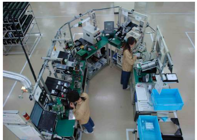
▲セル方式を採用し、お客様のニーズに応じてローコスト、短納期で様々なアプリケーションへの対応を可能にします。
