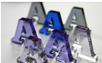
▲レーザー加工機を使用し、亚克力板切り文字を製作。厚さ 10 mm まで加工可能。
