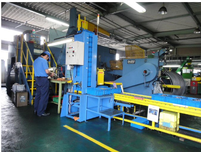
▲横型多段プレス様式のパーツフォーマー機。量産品の製造に向いている。
