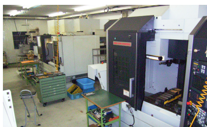
▲マシニングセンタ、NCフライス盤などが配置された部品加工工場。
