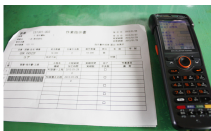
▲生産管理のPOPシステム。日々のデータを記録、蓄積し、材料ロスや不良品の発生原因を探る。
