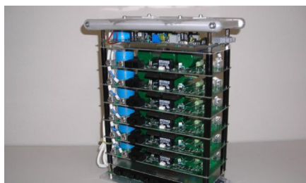
▲電子ビームを引き出すための電源。他社製に比べ、1/10の小型化に成功した。(高さ約22cm)
