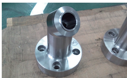
▲中で折れ曲がった穴を開けた一体金属部品
