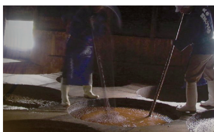
▲発酵を調整するためモロミに權を入れる。勤と経験が頼りだ。
