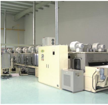
▲コンベア式電解イオン水洗浄装置
