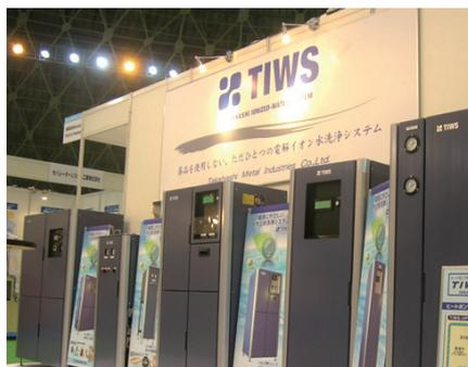
▲アルカリイオン水を利用して金属加工部品の洗浄ができる「TIWS」。
