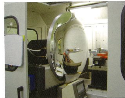
超精密非球面切削加工・ダイヤモンドターニングセンター。
