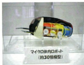
●最終開発目標のマイクロ体内ロボット模型 (W10×H10×D20mm 重さ5g)
