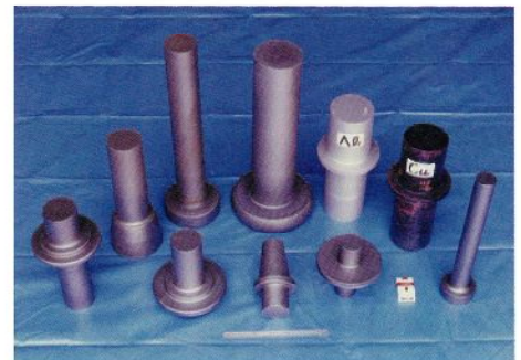
段付シャフトを材料・加工コストを安く鍛造
