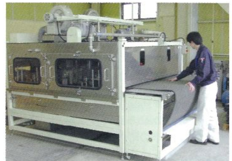
FPECブランド(Faction機能—Performance出来映え×Environment環境×Cost低価格)で洗剤を使わないマット洗浄を実現
