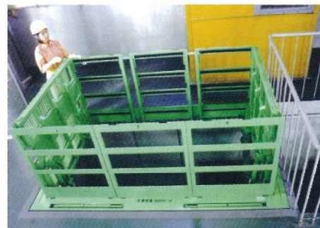
90ハッチ(安全柵一体型機器搬入開口用ハッチ)
