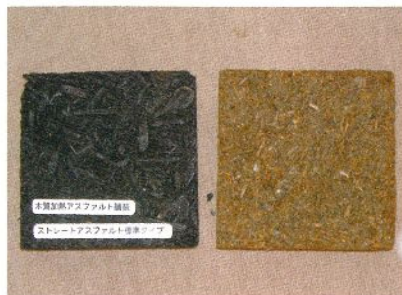
歩道舗装に使える強度を持つ木質アスファルト
