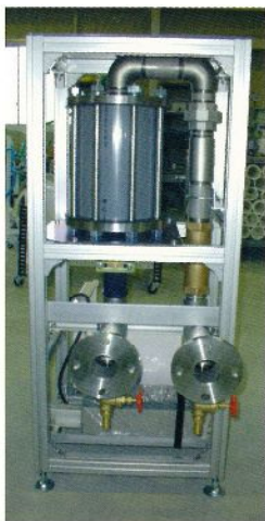
循環式吸着殺菌濾過装置
