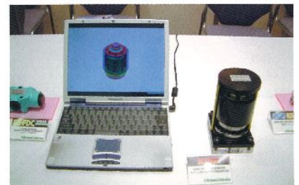
日本と米国で特許を取得した、回転型昇圧器。
