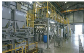
プラごみを有用なガスと活性炭に変え再利用する「廃プラ減溶炉システム」。これからの事業の柱として期待がかかる
