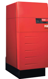
燃焼の際に発生するガスに含まれるH 2 Oの凝縮熱を利用し、100%を超える熱効率を実現した潜熱回収型ボイラ(UltraGasシリーズ)
